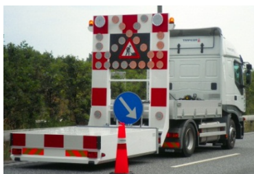
Figur 7.39 Eksempler på TMAer.
