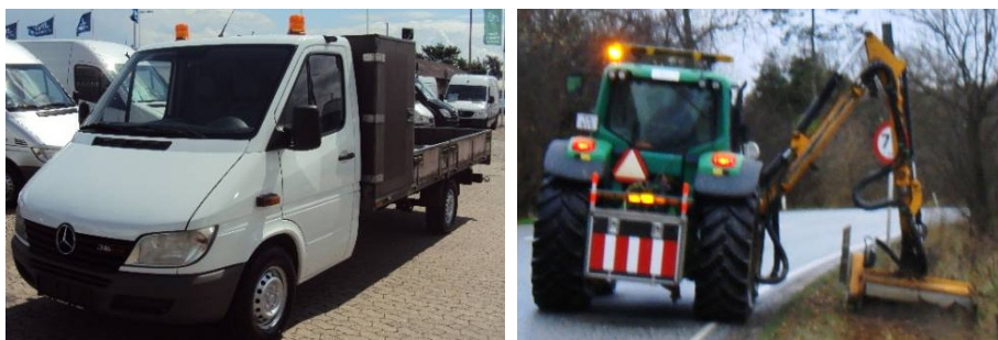
Figur 7.61 Eksempler på arbejdskøretøjer med afmærkningslygter.
